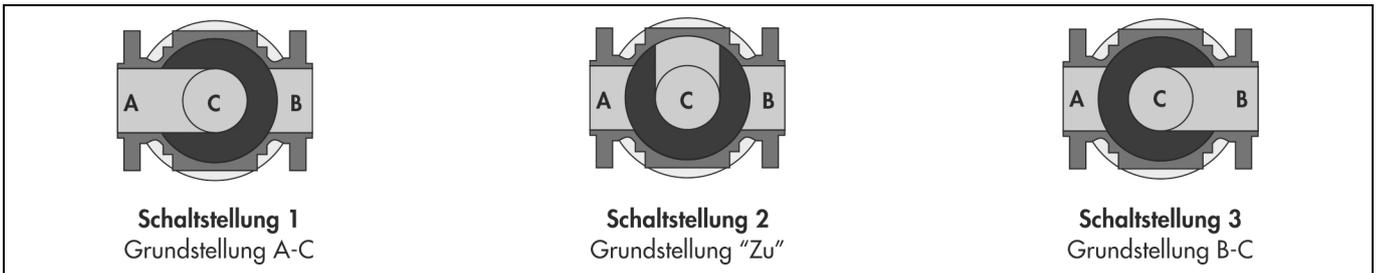
Bild 3: Schaltstellungen des 3-Wege Kugelhahns BR 26v
