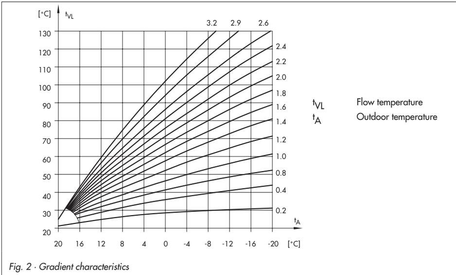
Fig. 2 · Gradient characteristics
