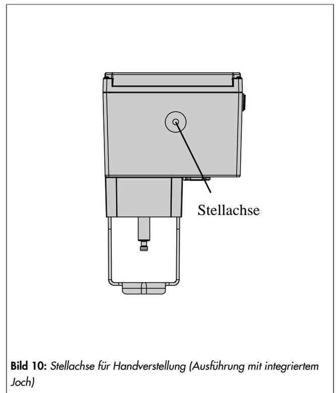
Bild 10: Stellachse für Handverstellung (Ausführung mit integriertem Joch)
