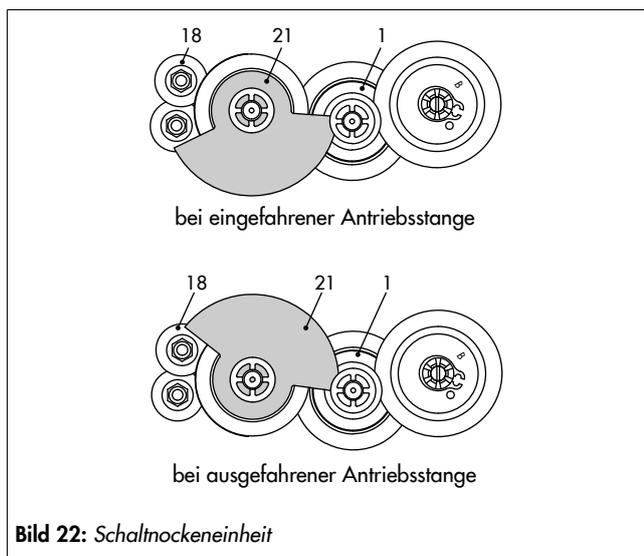
**Bild 22:** Schaltnockeneinheit
