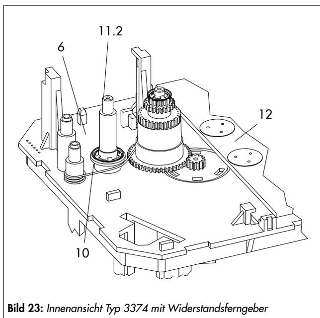
**Bild 23:** Innenansicht Typ 3374 mit Widerstandsferngeber
