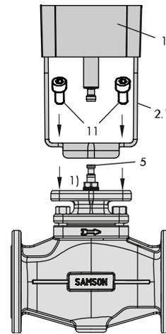
**Bild 12:** Anbau · Ausführung mit Antriebsjoch und Zubehör V2001
