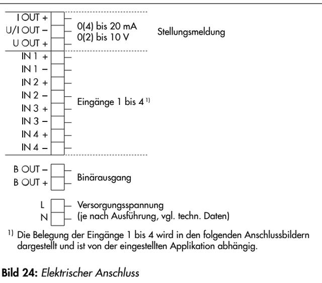
Bild 24: Elektrischer Anschluss
