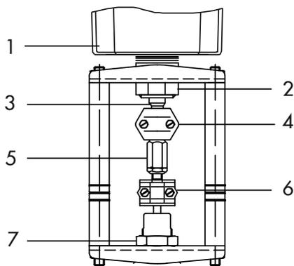
**Bild 18:** Anbau an Ventil Typ 3260 DN 65 bis 150 und Typ 3214 DN 125 bis 250, membranlastet
