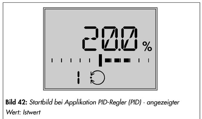
Bild 42: Startbild bei Applikation PID-Regler (PID) - angezeigter Wert: Istwert
