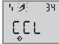
Schließrichtung (Drehrichtung, durch die die ZU-Stellung des Stellventils erreicht wird; Blickrichtung auf Display des Stellreglers)
