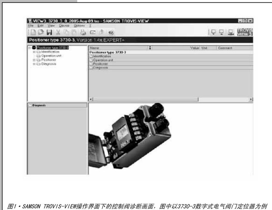
图1 • SAMSON TROVIS-VIEW操作界面下的控制阀诊断画面，图中以3730-3数字式电气阀门定位器为例
