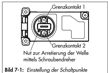
**Bild 7-1:** Einstellung der Schaltpunkte
