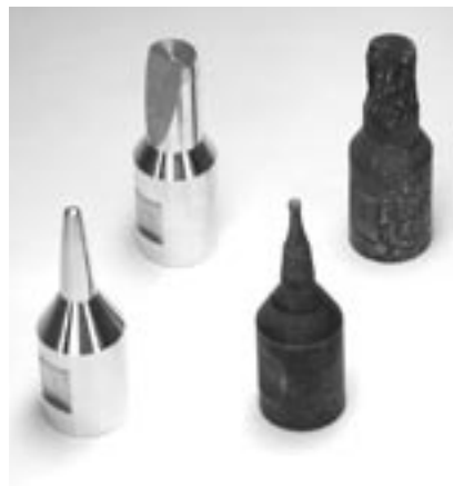
Abbildung 3: Typische Schäden durch Kavitation; die Kegel weisen massiven Materialabtrag auf.
