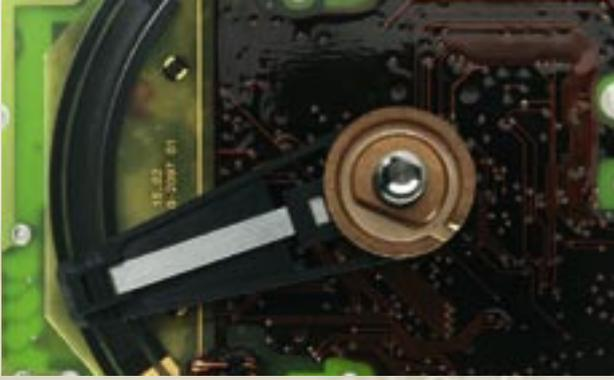
Der analoge Wegaufnehmer arbeitet ohne Getriebe verzugsfrei und präzise.
