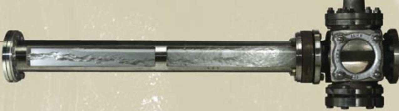
Der Einfluss der Zweiphasenströmung auf das Geräusch- und Erosionsverhalten wird auf der Flashingstrecke untersucht.
