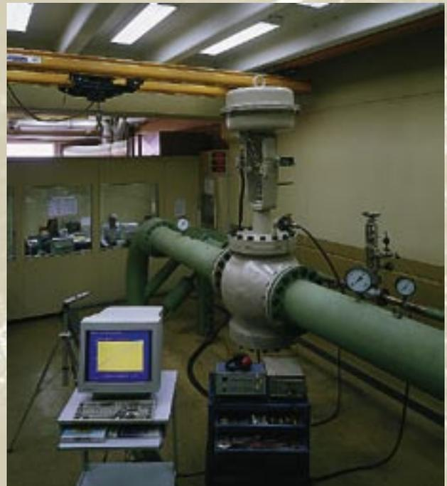
Automatisierte Messung der ventilspezifischen Kenngrößen über den gesamten Hubbereich.
