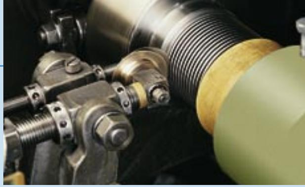
SAMSON fertigt seine Standardbälge aus korrosionsfestem Bandmaterial auf selbst entwickelten Maschinen.
