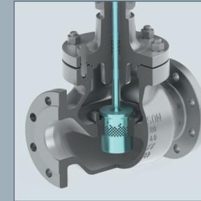
带多孔阀芯的控制阀主要用于蒸汽工况，特别是湿蒸汽工况。其他应用工况还包括两相流介质、在出口侧汽化的液体介质（闪蒸阀）或出口流速无法保持在0.3马赫以下排气的紧急排放阀（疏水阀）。
