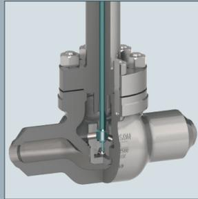
ZT-1内件适用于液体、两相流或气体在FTC（流关）方向的单级泄压。在特定工况下，这种阀内件可在一定压差时实现单级泄压。典型工况包括：泄压和临界蒸汽工况。
